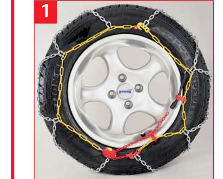
D Gumminspanner aus der Außenkette aushängen, rote Spannkette durch Drücken des gelben Knopfes der Ratsche lösen und roten Drehzahn aushängen.
