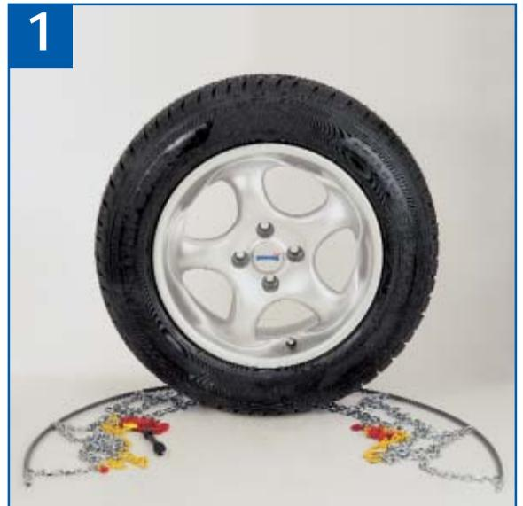
D Kette ordnen und geöffnet vor das Rad legen. Danach die Kette am Seil anfassen und hinter das Rad schieben, sodass der Kugelverschluss vorne zu liegen kommt.
