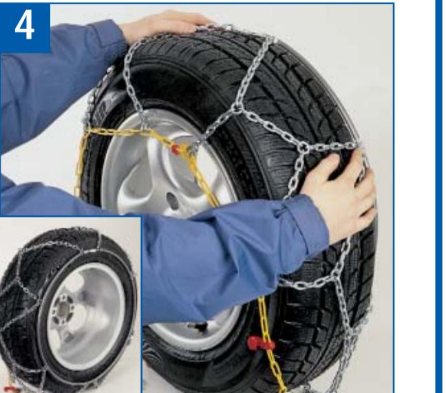
D Das Seil hinter das Rad schieben und darauf achten, dass sich weder das Seil noch ein Verschlussteil auf der Lauffläche befindet.
