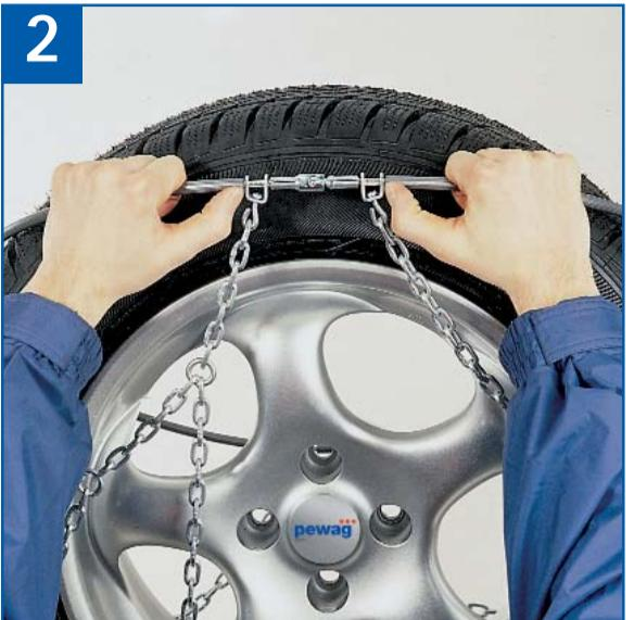
D Seil hochheben und den Kugelverschluß am oberen Teil des Reifens schließen.
