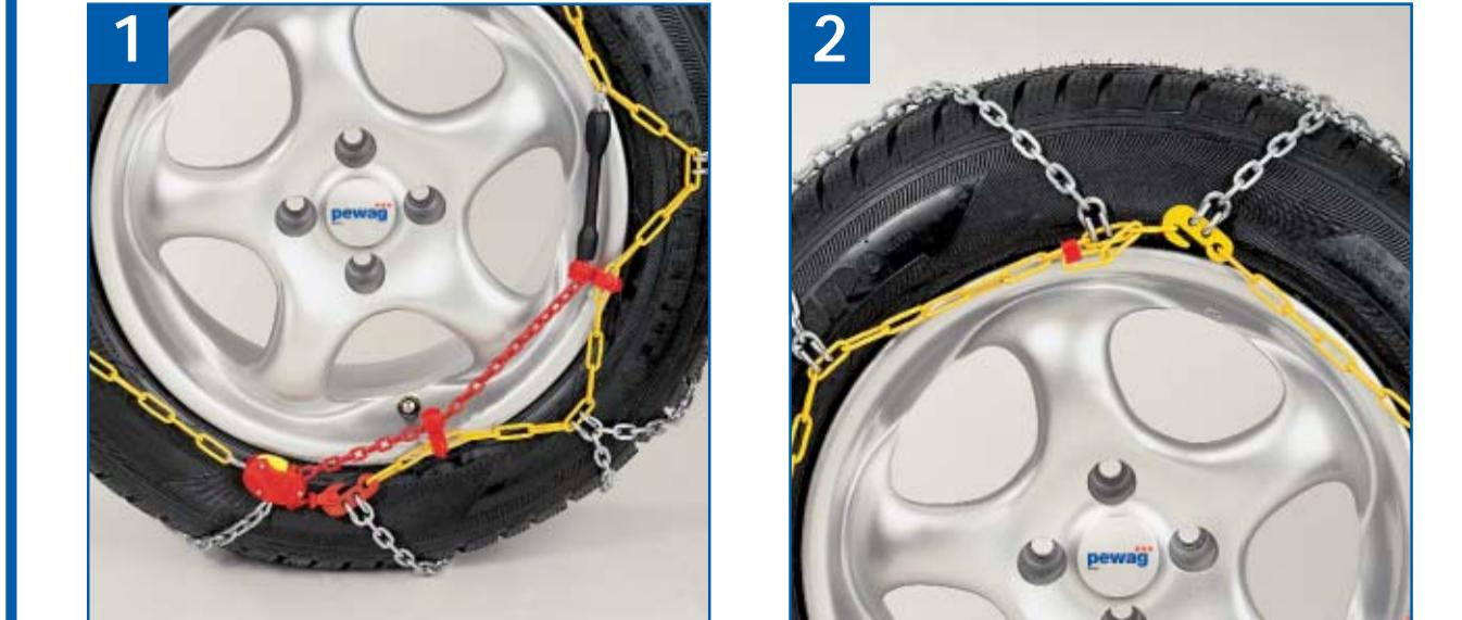
D Fahrzeug so zum Stehen bringen, dass die Ratsche sich in 6-Uhr Stellung befindet.
